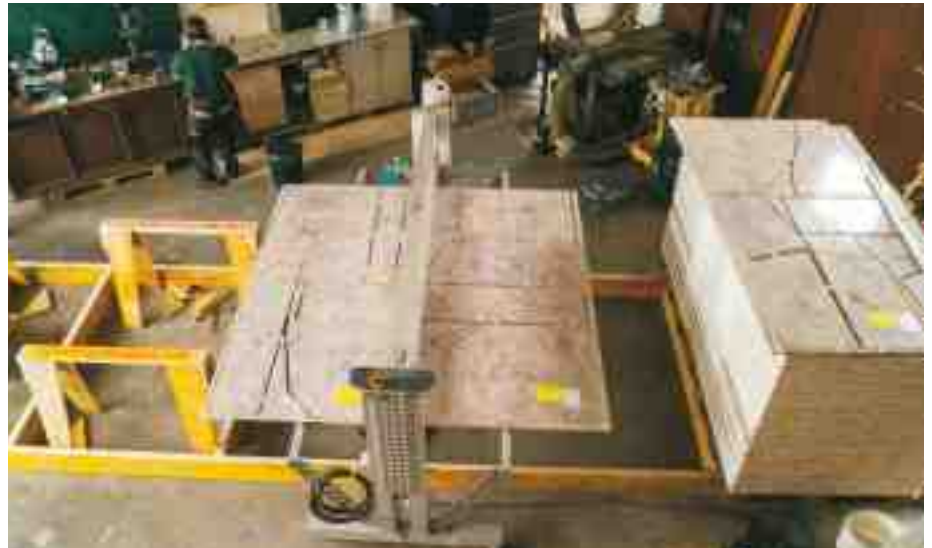
Anlieferung der Duflex-Platten ins Wertzelt (r. o.)/ Die vorgefrähten Duflex-Platten werden mit einer speziellen Presse zu Panels verklebt (r. m.)/ Ein fertiges Rumpf-Segment, herausgelöst aus einem Panel (r. u.)
