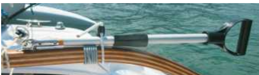
oben: Sicherungsbolzen für Pinnenausleger unten: Pinnenausleger mit Schaufelgriff
