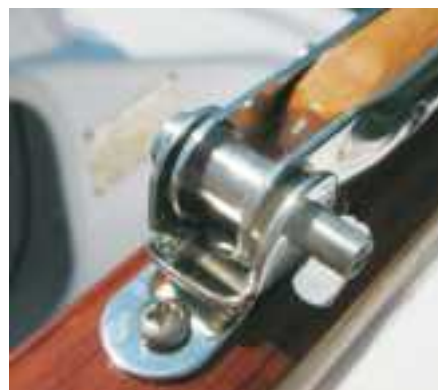
oben: Sicherungsbolzen für Pinnenausleger unten: Pinnenausleger mit Schaufelgriff
